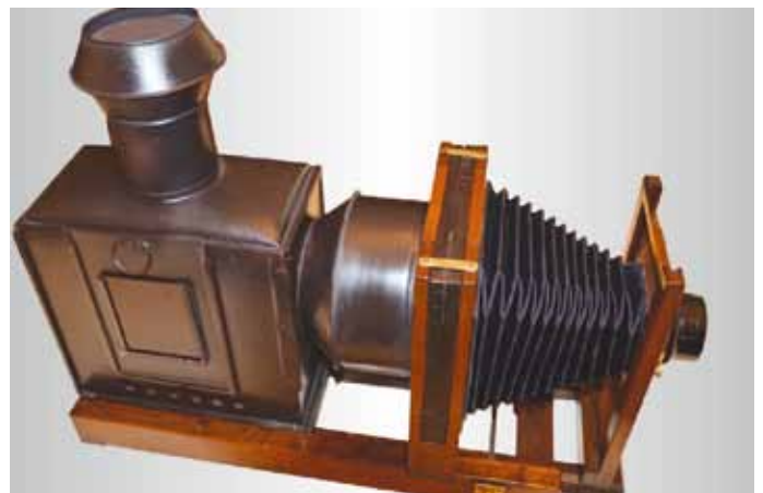
Lichtdichter Faltenbalg an einem restaurierten Vergrößerungsgerät.
