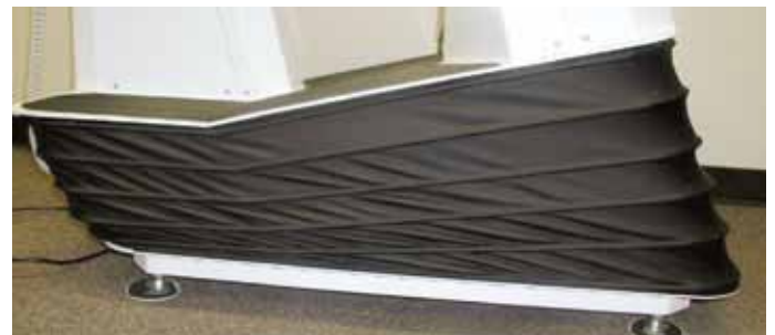
Rundum geschlossene Gorframe-Abdeckungen schützen das Innere eines Neigungstisches, wobei sie Bewegungen in unterschiedlichste Richtungen auffangen.
