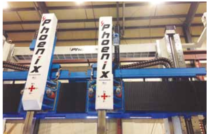
Faltenbälge als Querbalkenabdeckung und Nylatrac-Kunststoff-Energieführungen mit langen Verfahrwegen an einem vertikalen Bearbeitungszentrum.
