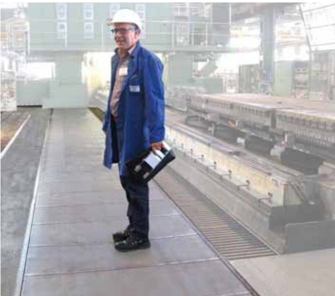
Begehbare Steelflex-Abdeckungen sind praxiserprobt und werden schon seit Jahrzehnten zum Schutz von Personen und Maschinen auf Führungsbahnen und Inspektionsgruben eingesetzt.
