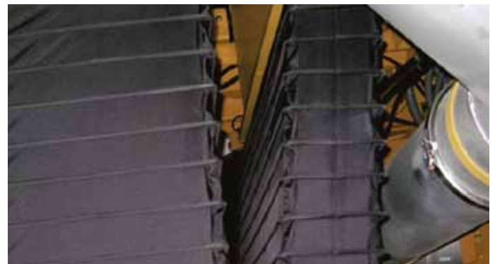
Gorframe-Faltenbälge für Luftkanäle an einem Schwerlastwagen.
